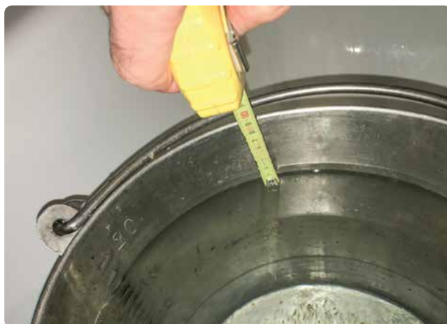
OBR. 2 Změřte hladinu pro zjištění objemu vody
